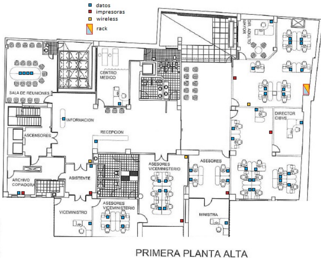
Gráfico No. 8: Plano descriptivo de la red en el Piso Uno
