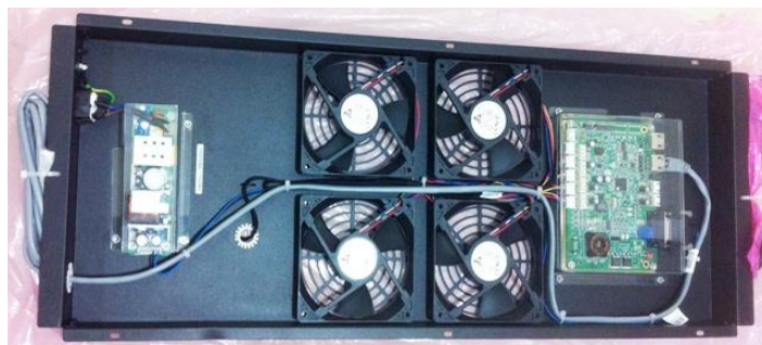
Figura 2.6 Cuatro ventiladores con velocidad ajustable.
