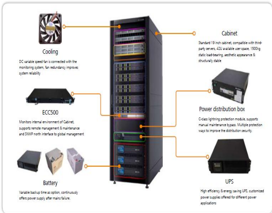
Figura 2.10 Versión básica del Mini Data Center Modular IDS2000-S.
