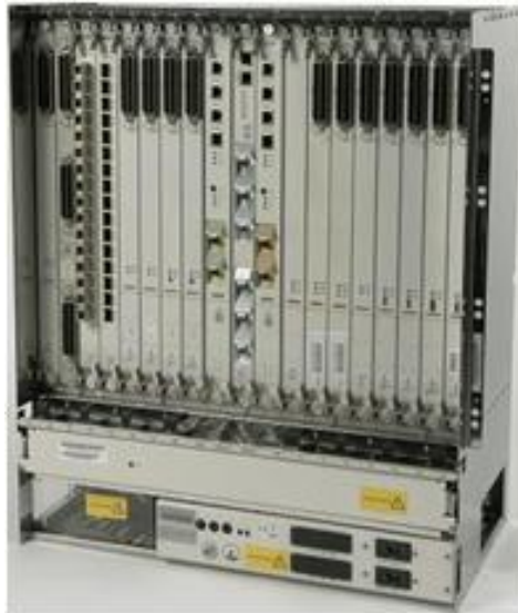
Figura 3. 9 DSLAM ISAM 7302 Fuente: Investigador
