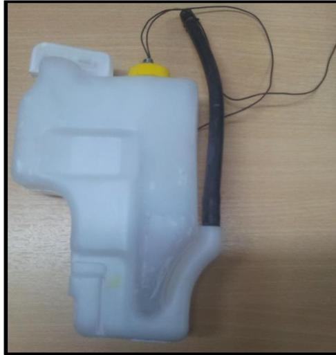
Figura 3.13 Sensor dentro del recipiente de líquido refrigerante
