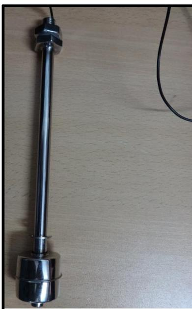
*Figura 3.7 Sensor de nivel vertical tipo boya*
