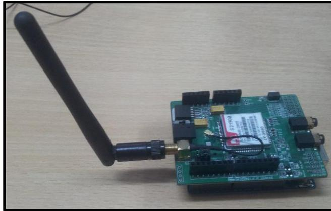
Figura 3.8 GPRS Shield y Arduino UNO interconectados
