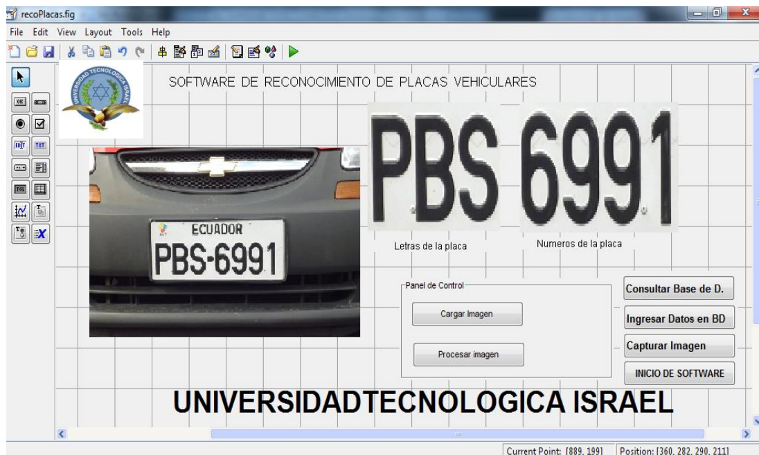
Figura 3- 21. Diseño de visualización Gráfica GUIDE según Prototipo. (Fuente: Autor.).
