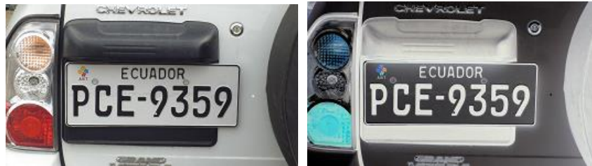
Figura 2- 2. Imagen original (der.), su dilatación y erosión (izq.) (Fuente: Autor.).
