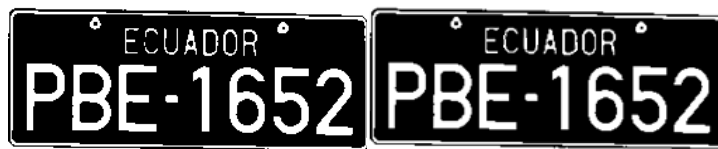
Figura 4- 4. Algoritmo de Umbralización, (der.) Algoritmo Morfológico (izq.) (Fuente: Autor.).
