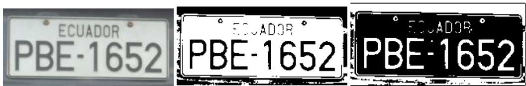
Figura 4- 3. Algoritmos Morfológicos, Imagen Filtrada y Presencia de ruido. (Fuente: Autor.).
