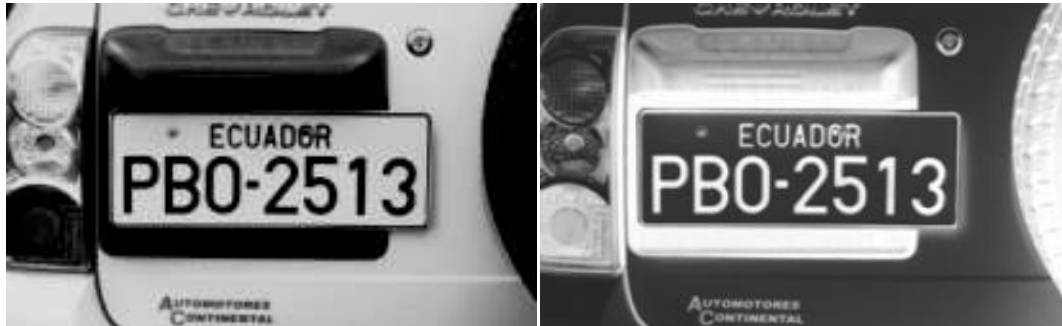
Figura 3- 17. Resultados de Filtros de eliminación de Ruido y Binarización. (Fuente: Autor.).
