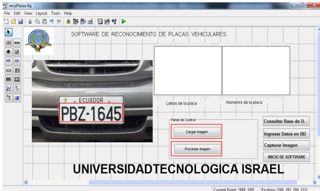
Figura 4- 9. Proceso de Inicialización de GUI en MatLab. (Fuente: Autor.).
