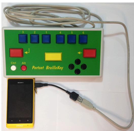
Fig. 3.44. Cable OTG conectado al teléfono celular.
