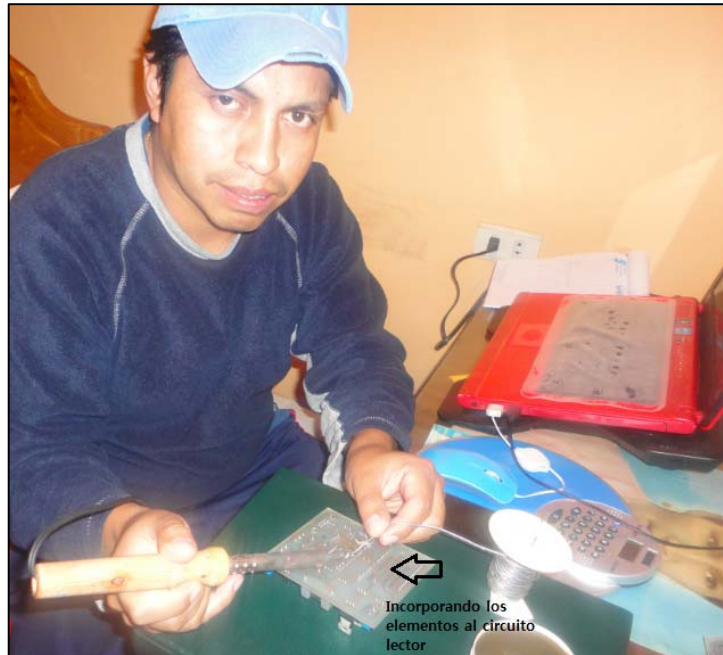
Figura 3-50 Incorporando los elementos al circuito grabador.
