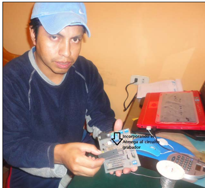
Figura 3-51 Incorporando el Atmega164P al circuito grabador.
