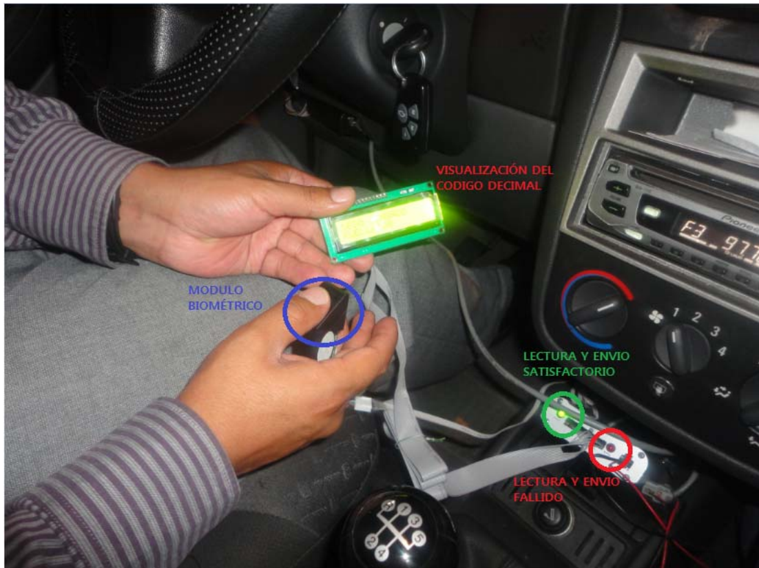
Figura 8.1 LCD y Leds Indicadores del Estado del Sistema
