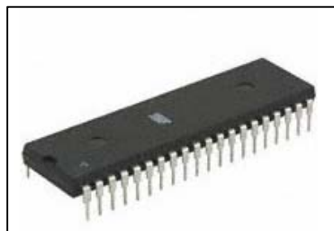
Figura 2-19 Circuito integrado del ATMEGA164P.
