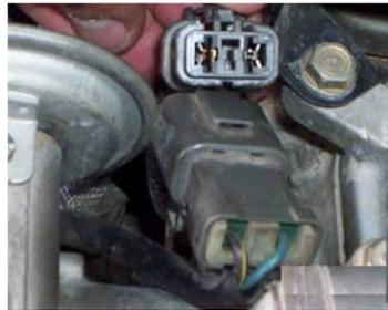
Figura 4.1: Conector de alimentación al módulo de encendido.
