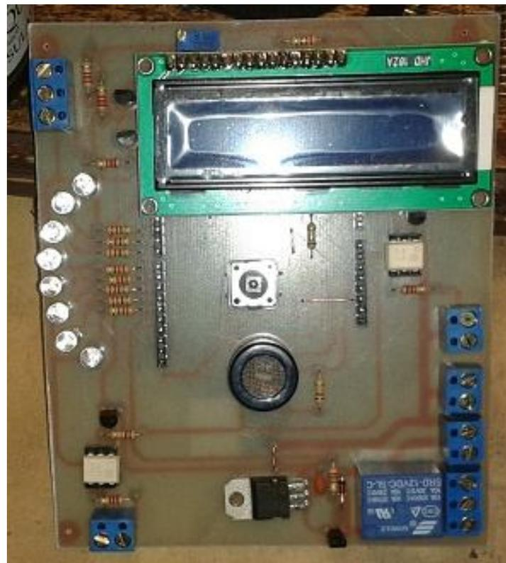
Figura 3.15: Implementación de circuito del alcoholímetro.
