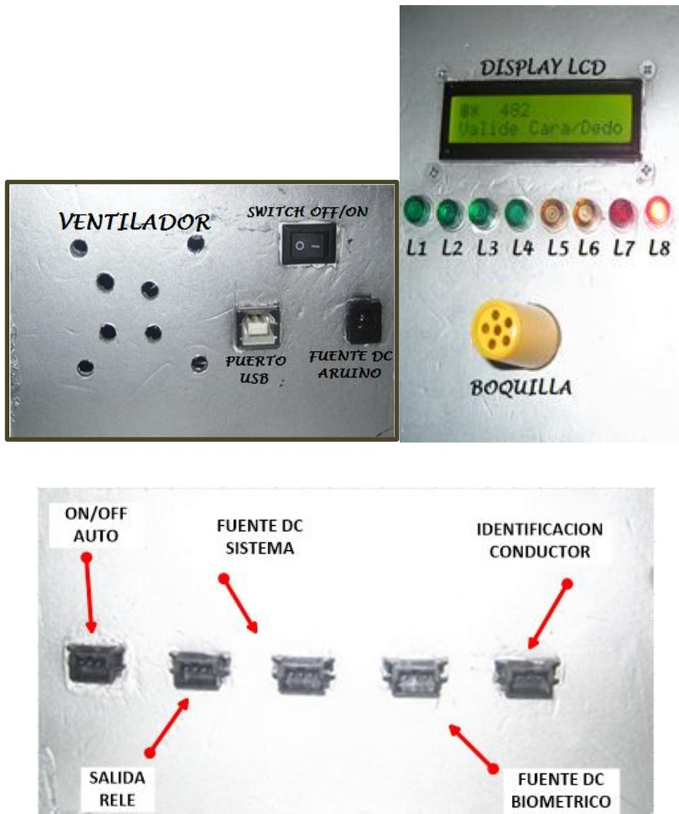
Figura 1. Distribución de los conectores en la caja.
