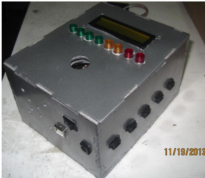
Figura 3.16: Caja del circuito del alcoholímetro.
