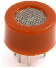
Figura 2.5: Sensor detector de alcohol MQ-3.
