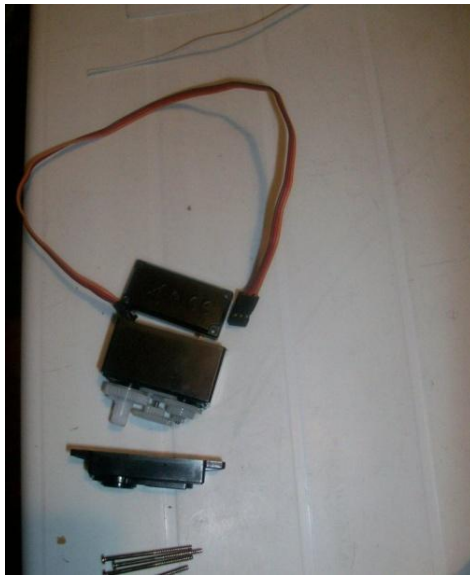
Ilustración 39. Componentes del servomotor
