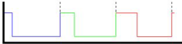
Ilustración 5. PWM para recorrer todo el rango de operación del servo
