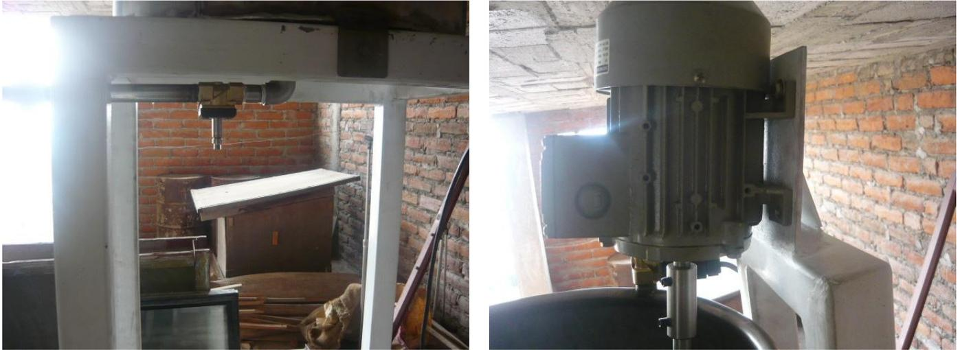
**Fig 3.102** Implementación de Elv. De 2/2 vias y el motor de mezcla
