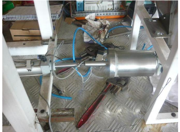
**Fig 3.90** Adaptación del cilindro de carga al pistón
