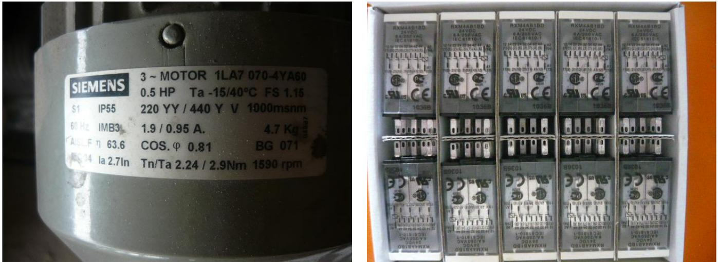
Fig 3.100 Características del motor de mezclado y banda transportadora con relés a usarse
