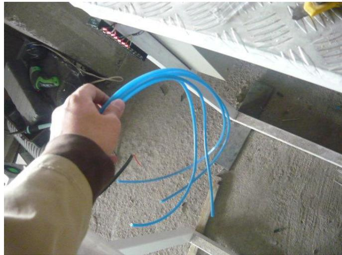
**Fig 3.110** Instalación de los pistones de envasado y mangueras neumáticas
