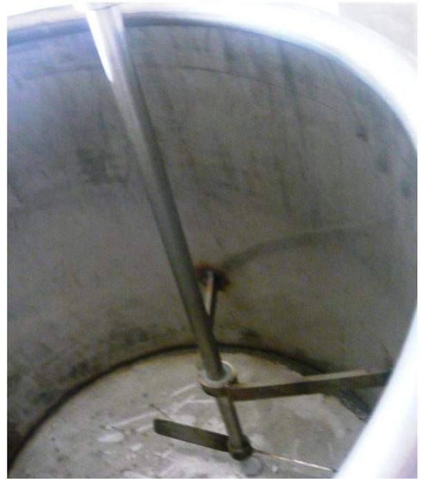
**Fig 3.82** Construcción e implementación de la paleta de mezclado añadida al tanque de mezcla
