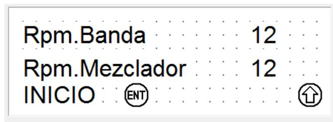
**Fig 3.67** Selección independiente de rpm en la banda y mezclador
