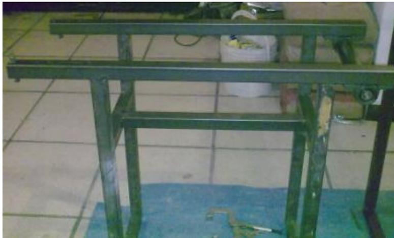
**Fig 3.88** Construcción de la estructura metálica de la mesa para la banda transportadora
