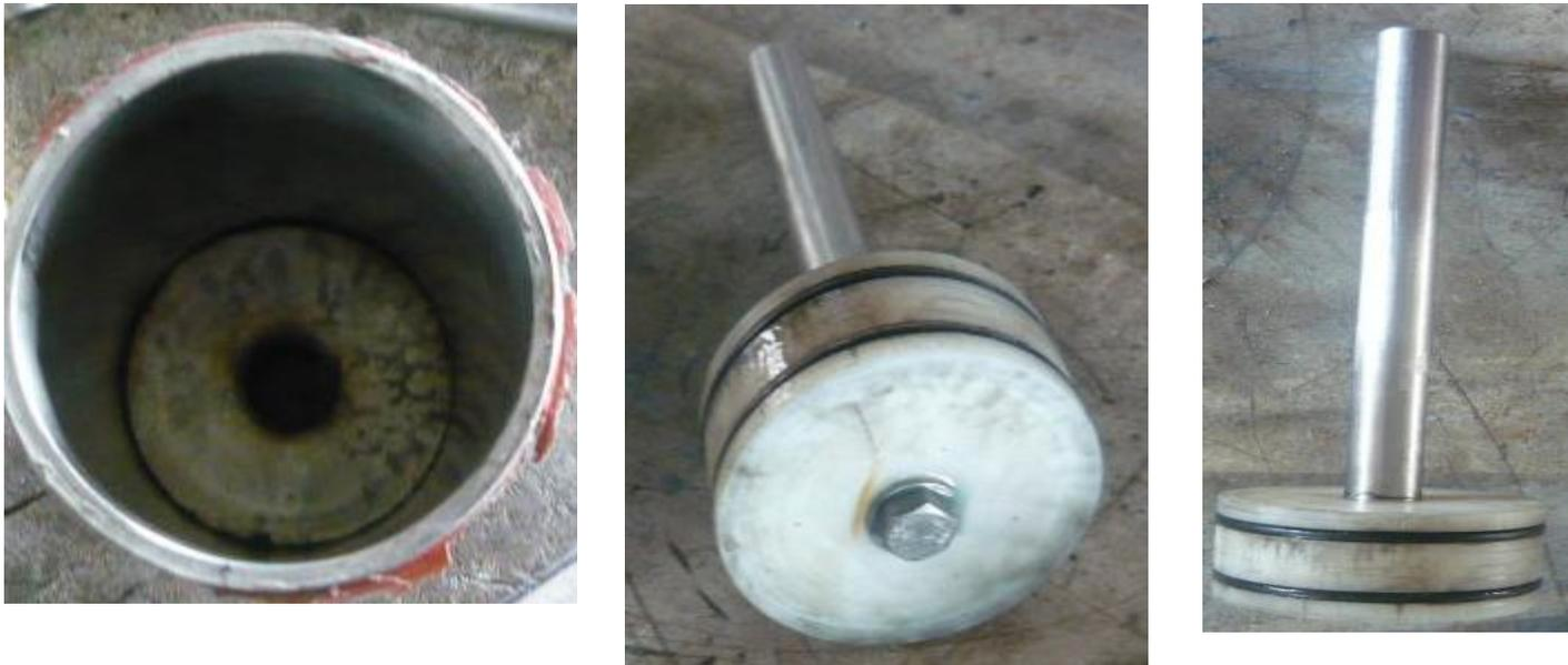
**Fig 3.86** Construcción de la estructura metálica del cilindro de carga y descarga de líquidos
