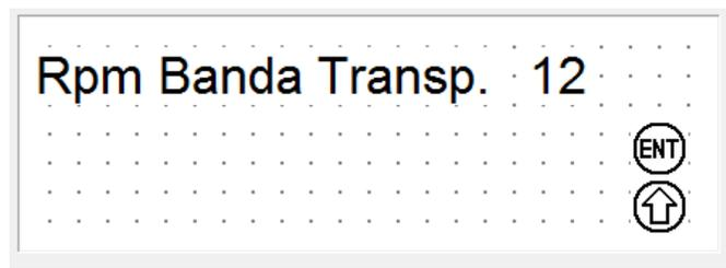
**Fig 3.69** Selección independiente de rpm la banda transportadora
