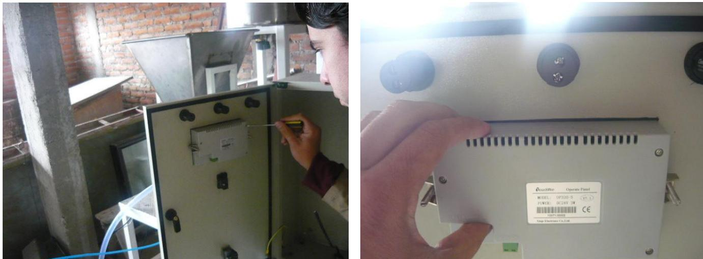
Fig 3.104 Instalación del Hmi
