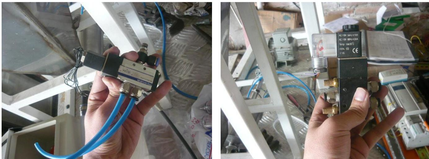
Fig 3.99 Electroválvulas de 5/2 vías
