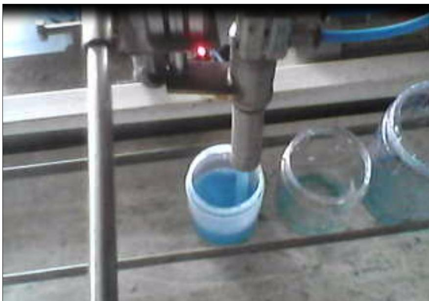
**Fig 3.115** Pruebas de envasado sensor fotoeléctrico
