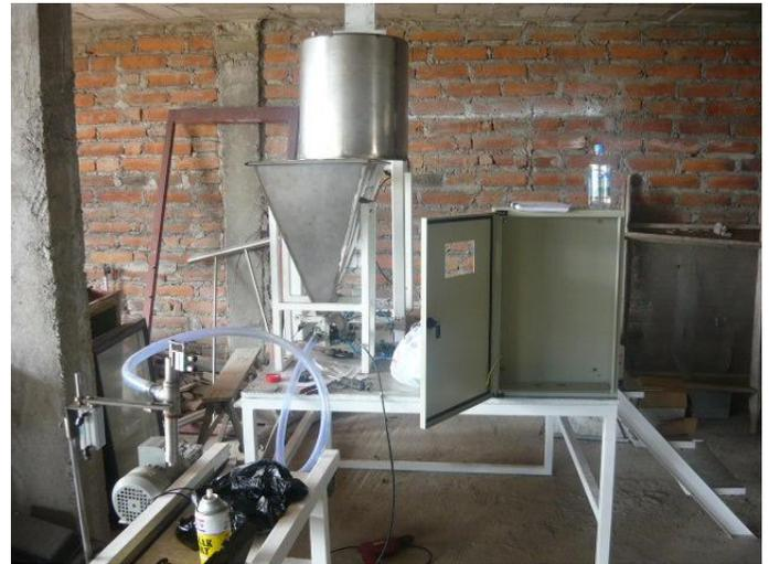
**Fig 3.91** Implementación del tablero de control a la mesa de trabajo
