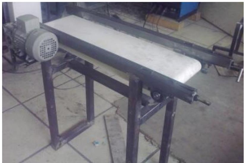
**Fig 3.89** Implementación de la banda transportadora a la mesa
