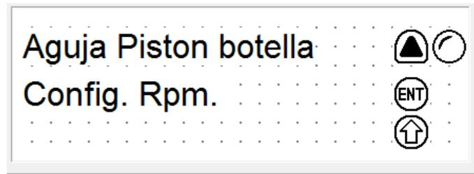
**Fig 3.66** Selección independiente en modo manual para aguja anti goteo y rpm
