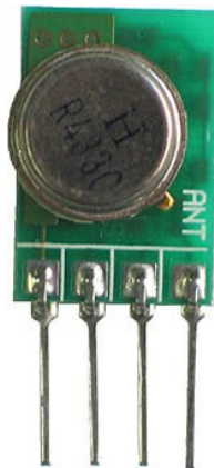
Figura 2.6: Modulo de Transmisi3n TLP 434 A. 17
