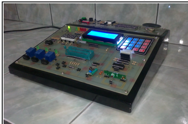
Figura 3.39: Entrenador Lógico armado y terminado (a).
