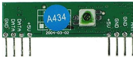
Figura 2.7: Módulo de Recepción RLP 434 A. 19
