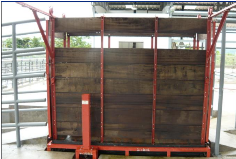
Figura 97 Balanza para ganado en pie (Bovino y Porcino) Marca SISBAL, capacidad 500 Kg para porcino y 1000 Kg para Bovino
