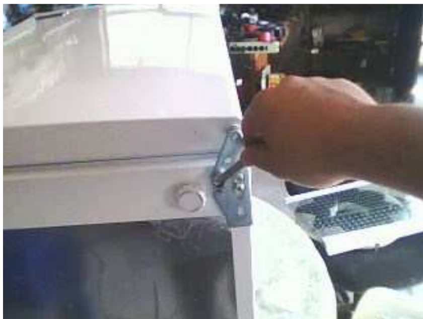
Figura 36: Desacople de la puerta del refrigerador
