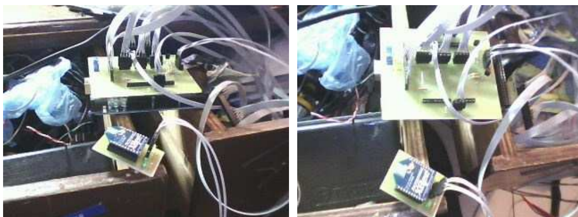
Figura 43. Sistema de control ensamblado, consta de escudo para ARDUINO-MEGA, cables para sensores ultrasónicos, sensor de temperatura LM35 y visualizador LCD 16x2.
