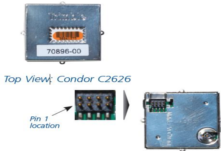
Figura 5. Tarjeta Receptora GPS. Trimble modelo C2626.
