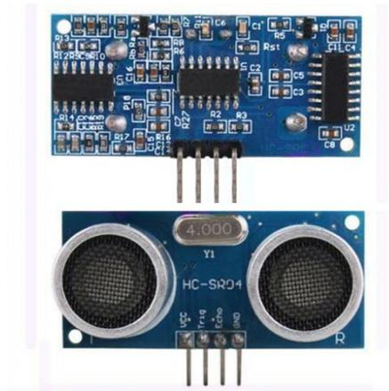
FIG. 2.2 Sensor de ultrasonido HC-SR04.
