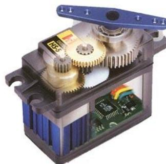
FIG. 2.18 Diagrama de servomotor
