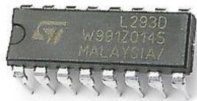
FIG. 2.11 Diagrama de puente H L293d
