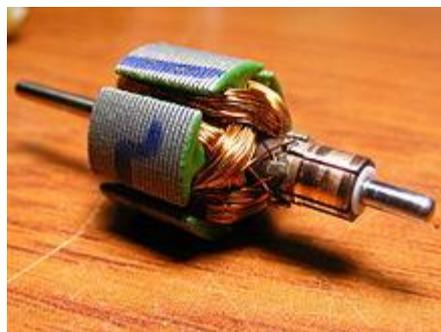
FIG. 2.3 Un rotor de un motor de 12V, con imanes de dos polos, cinco devanados, cinco delgas y dos escobillas.
