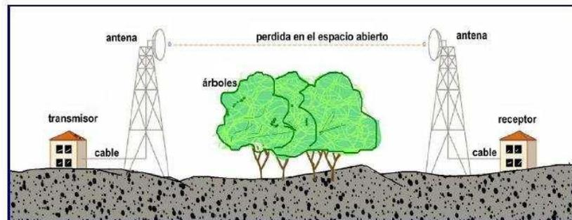
Fig. 1.12 Trayectoria completa de transmisión entre el transmisor y el receptor
