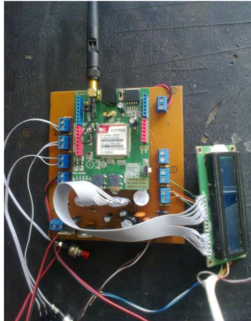
Figura 3.15 Conexión del modem GSM al Shield Fuente: (Elaboración propia)
