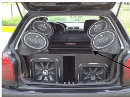
Gráfico No 17 Modelo de caja de fibra de vidrio
