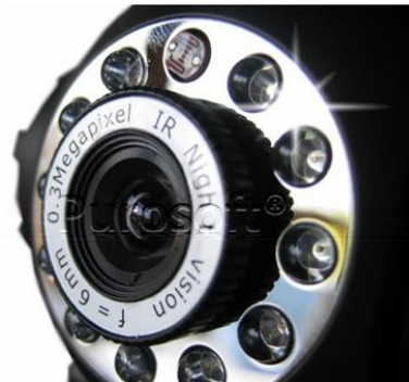
Fig.: 18 11 Poderosos leds infrarrojos para tener iluminación total aún en condiciones con 0 visibilidad nocturna.
