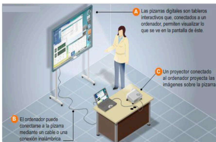
Figura 21. Funcionamiento de la Pizarra
