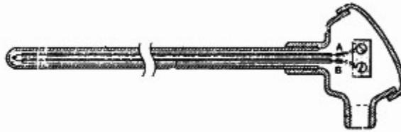
Fig. 2.11 Diseño de una termocupla con carcasa cerrada en el extremo
