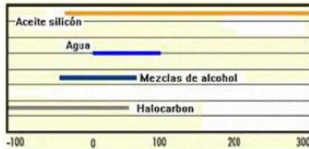
Fig. 2.32 Temperaturas que alcanzan las sustancias para esta aplicación medida en °C<sup>93</sup>
