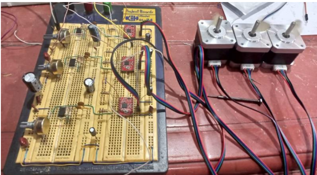
Pruebas de Funcionamiento de los Motores para Sincronizar el Movimiento Cartesiano
