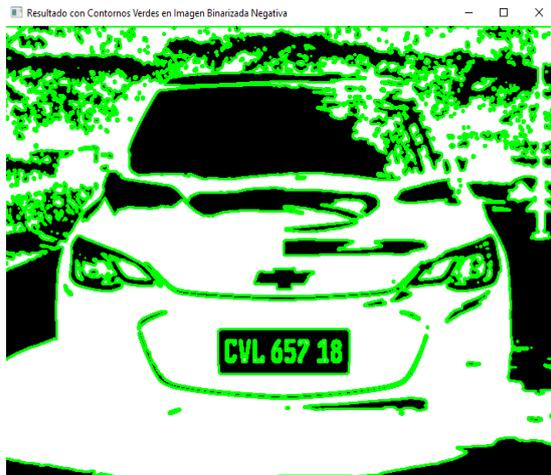
Después de completar este proceso, se obtiene la impresión del valor de la placa detectada y se muestra en pantalla dicha identificación, como se indica en la ilustración 20. A continuación, esta información se compara con la lista de placas permitidas para el acceso al domicilio. Este procedimiento asegura que solo los vehículos autorizados sean admitidos.
