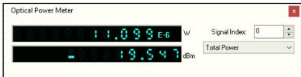
Figura 35.- Potencia en la ONT
