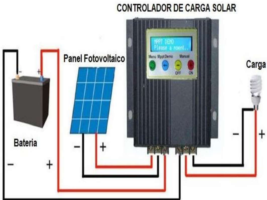
Figura. 18 Esquema del sistema de energía solar
