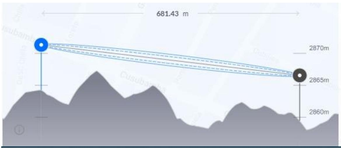
*Nota, a un alcance de 681.43 m, altura del transmisor de 6.40 m y altura receptor 6,80 m*
