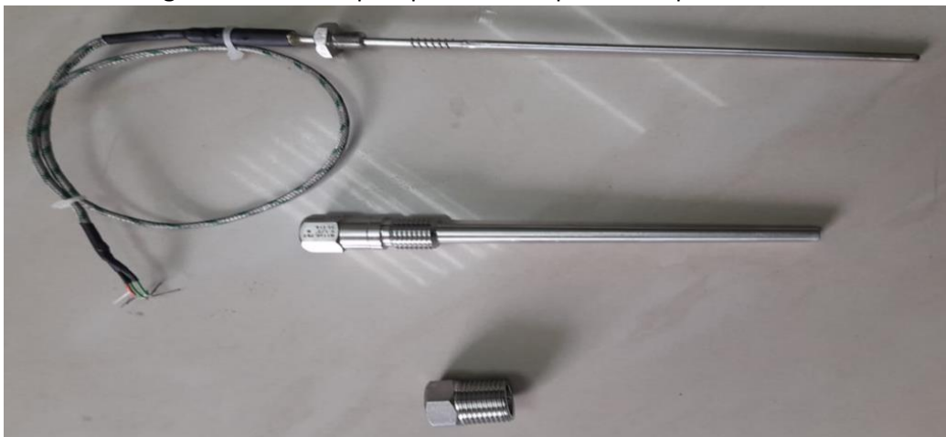
Figura 34: Termocupla tipo K – Termopozo – Acople Reductor
