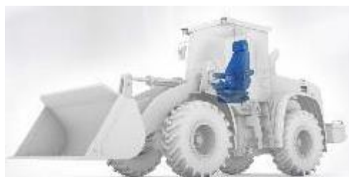
Figura 53 Puesto de Operadores de Maquinaria
