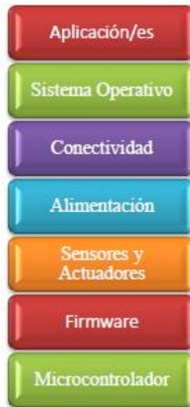
Figura 1 Componentes del objeto IoT
