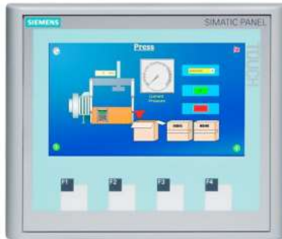
Figura 16. Pantalla HMI. Fuente: Siemens (2020)
