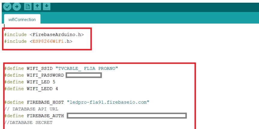
Figura 14: Declaración de credenciales Firebase en Arduino. Fuente: Del autor.
