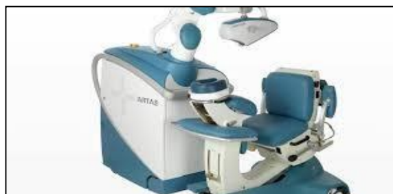
Figura 1. 11. Robot ARTAS para trasplante de pelo Fuente: Sánchez, 2014
