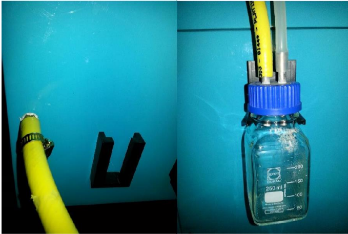
Figura 12. Conexión manguera de presión. Fuente: Chalá 2020
