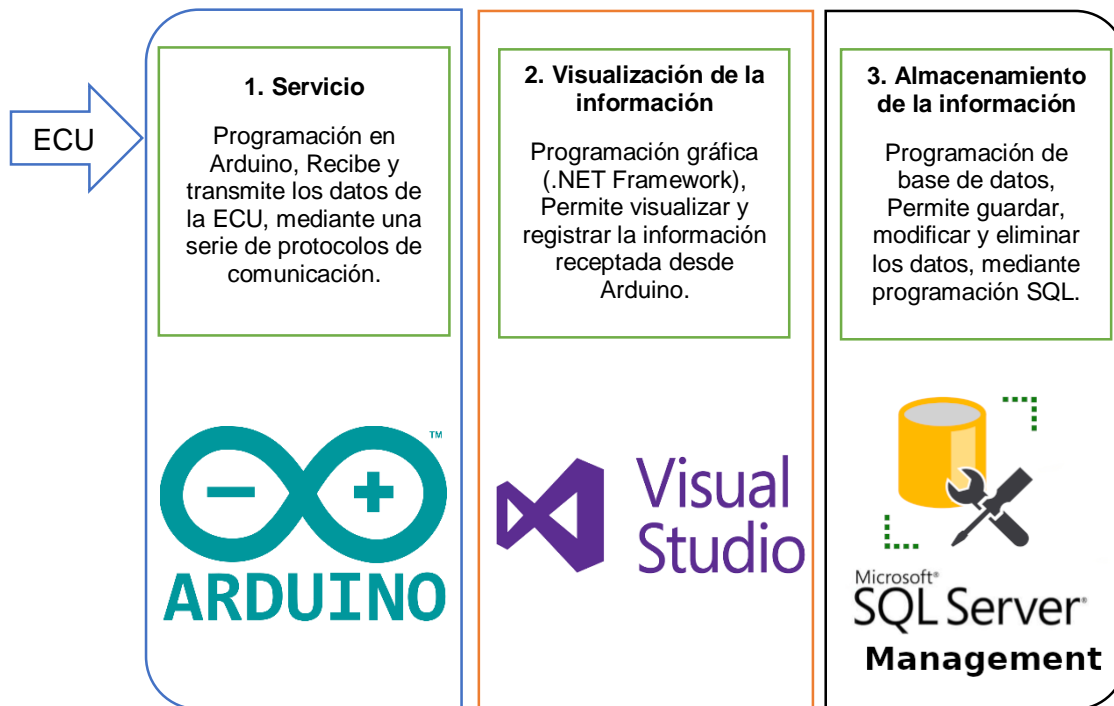
Figura 3.4.1 Sistema de transmisión, recepción y almacenamiento.
