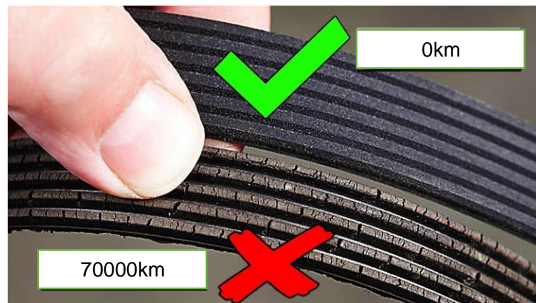
Figura 3.1.5 Correa de distribución nueva versus agrietada.
