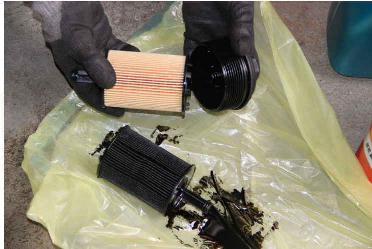
Figura 3.1.2 Filtro de combustible nuevo versus desgastado.
