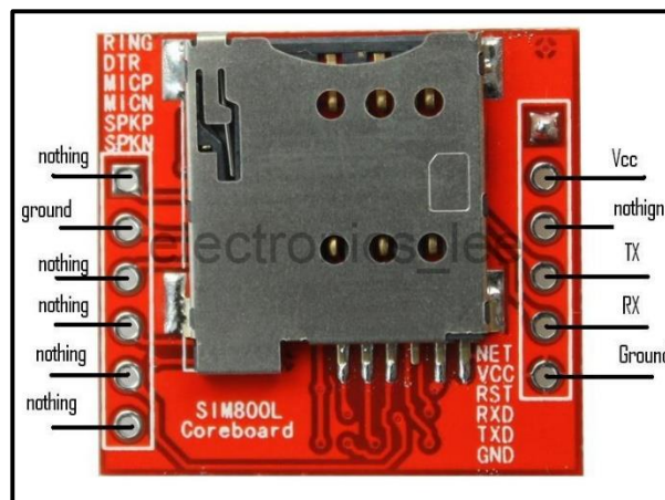
Figura 3.10 Pinout GSM SIM 800L
