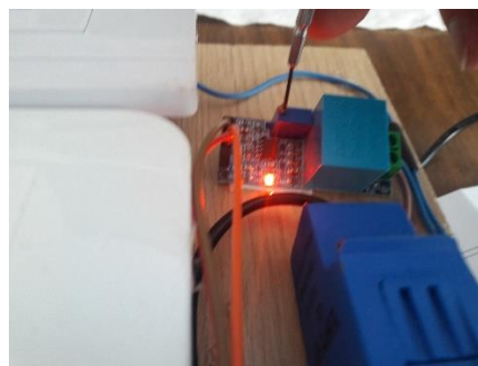
Figura 3.12 Tornillo de ajuste para la calibración del sensor Fuente: Elaborado por el autor
