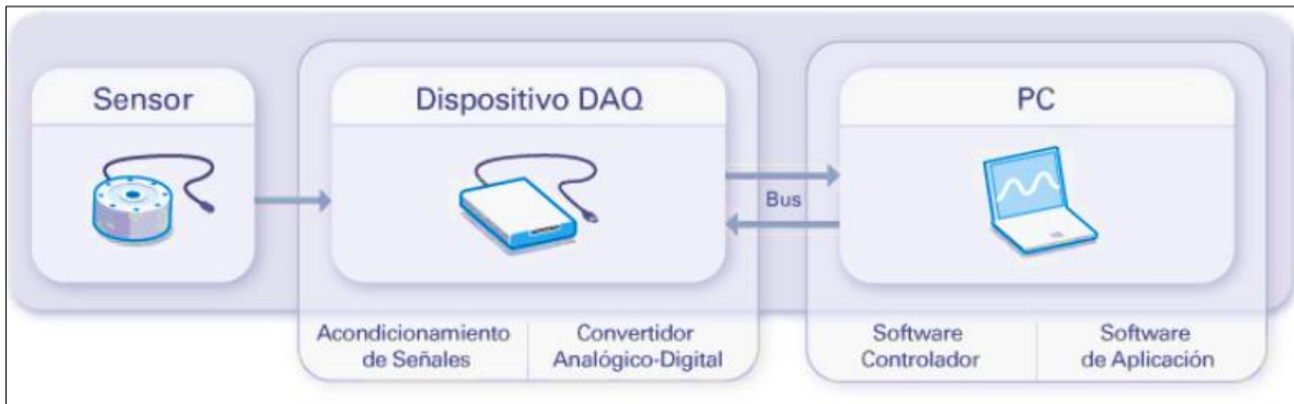
Figura. 2. 2. Partes de un sistema DAQ. Fuente: National Instruments. (2018). ¿Qué es adquisición de datos?
