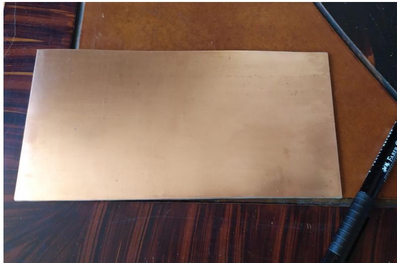
Figura 4.1. Limpieza del sustrato para el grabado
