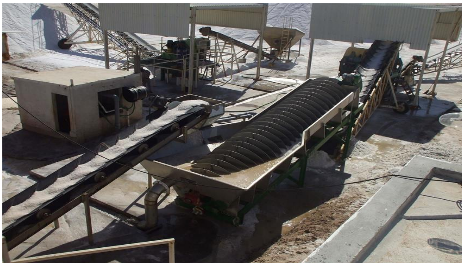
Figura 17 Proceso de lavado y centrifugado de sal en grano.
