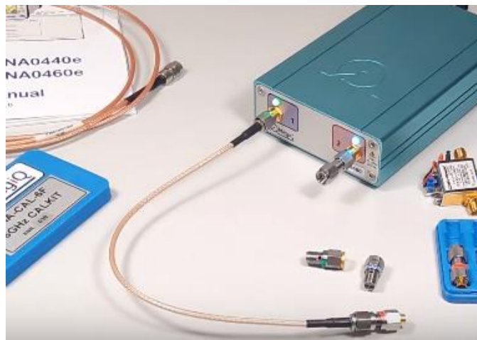
Figura 4.24 VNA con su kit de calibración y filtro a medir Fuente: Elaborado por el autor
