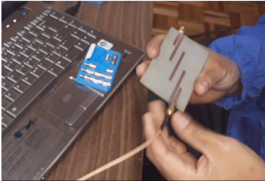
Figura 4.26 Conexión del filtro en el VNA Fuente: Elaborado por el autor
