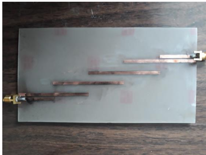
Figura 4.23 Prototipo del filtro terminado Fuente: (Elaborado por el autor)
