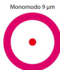
Figura 1.12 Fibra óptica monomodo
