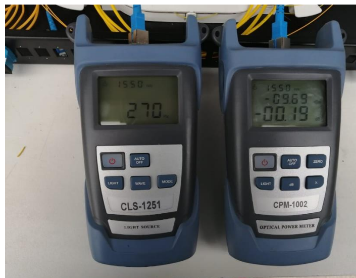
Figura 4.12 Pruebas de medida de potencia en enlaces
