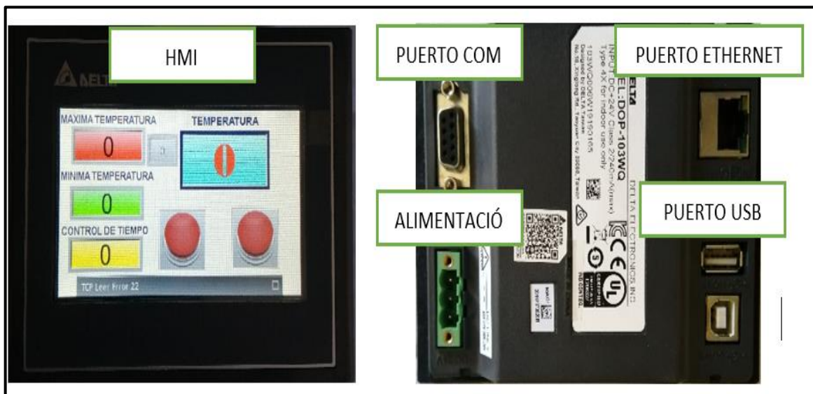
Figura. 3. 8. HMI Delta DOP-100
