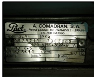
Figura. 4. 19. Placa de motor trifásico
