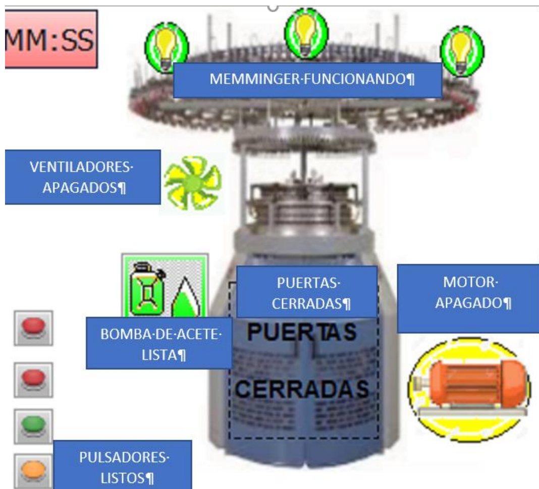
Figura 3. Funcionamiento de la HMI
