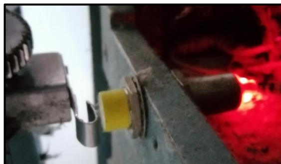
Figura. 4. 14 Conexión de sensor inductivo
