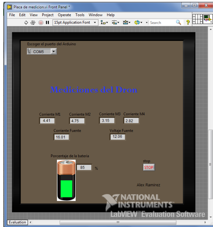
Figura 4. 38 Interfaz HMI online de sistema de medición (rotores y batería)
