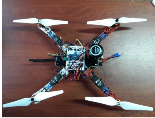
Figura 4. 23 Tarjeta electrónica de control instalada en el Drone F450-APM 2.8 de prueba
