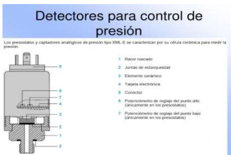
Figura 1.5. Elementos detectores y captadores
