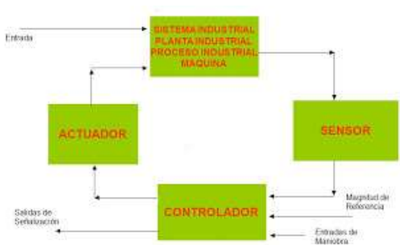
Figura 1.7. Estructura de una automatización
