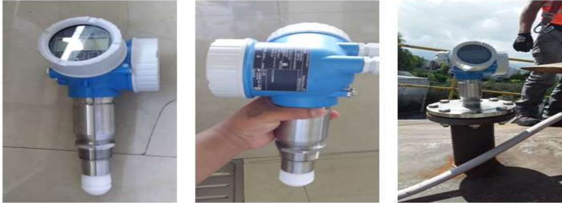
Figura 4. 3. Ensamblaje de sensor en la parte superior de la tolva
