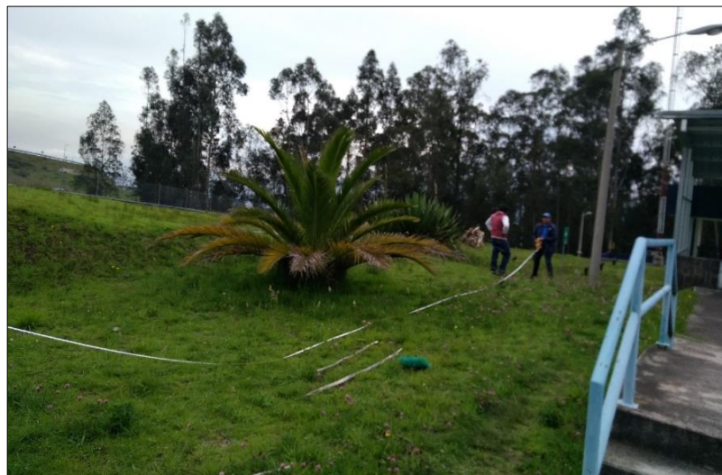
Figura. 4.2. Medición de la distancia del cableado Fuente: Elaborado por el autor
