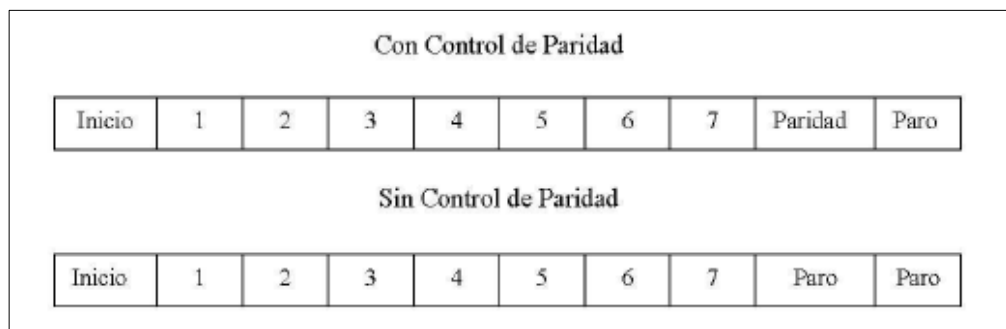
Figura. 1.16. Orden de bits en una trama ASCII
