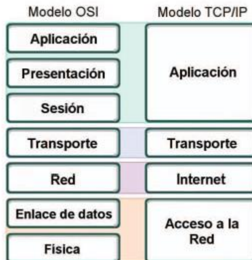
Figura. 1.22. Comparación entre los Modelos OSI y TCP/IP Fuente: (CCNA Network Fundamentals, 2020)
