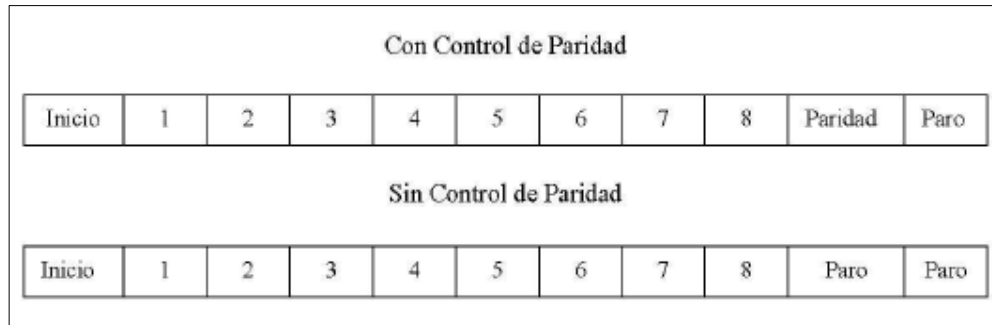
Figura. 1.17. Orden de bits en una trama RTU Fuente: (León Araujo, 2019)
