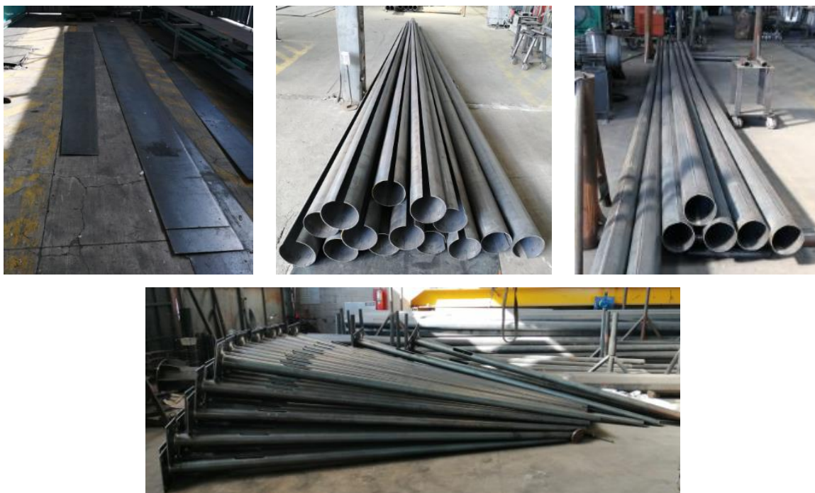
Figura 1.3 Proceso de producción de postes cónicos en industrias SEBLAN
