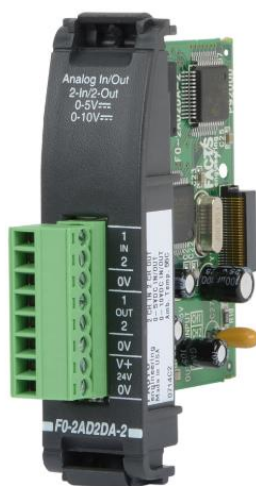
Figura 1.9 Módulo analógico F0-2AD2DA-2
