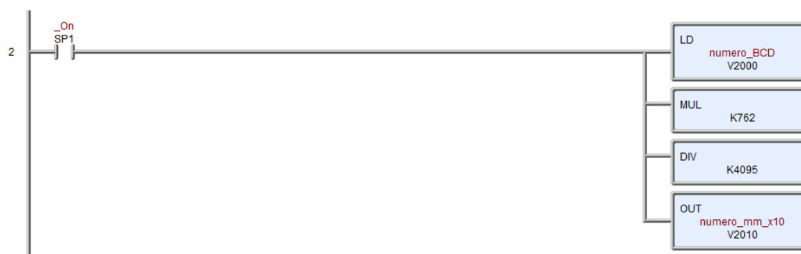
Figura 4.9 Escalamiento de señal analógica
