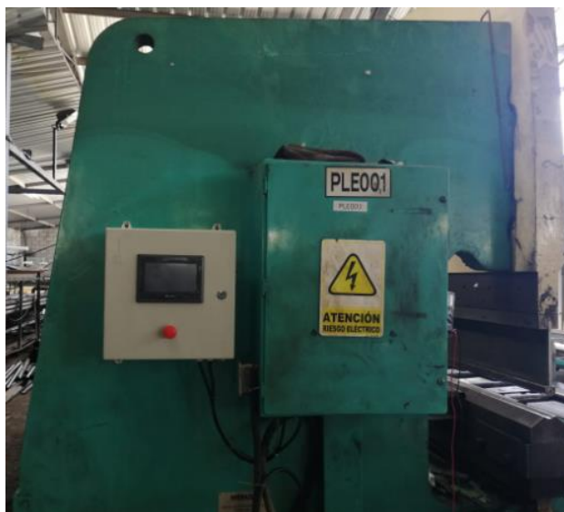
Figura 4.27 Instalación del gabinete en la plegadora
