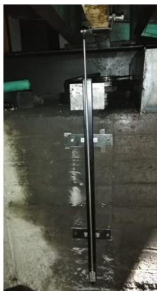
Figura 4.28 Instalación del sensor Turck en la plegadora
