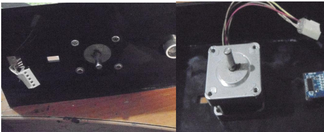
Figura 4.5 Instalacion de motor Bipolar
