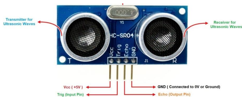
Figura 1.7. Sensor ultrasónico HCSR 04. Fuente: (Equipo de laboratorio didáctico, 2018).
