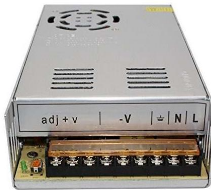
Figura 1.14. Fuente de Alimentación 12v 30 A. Fuente: (ONROM, 2020)
