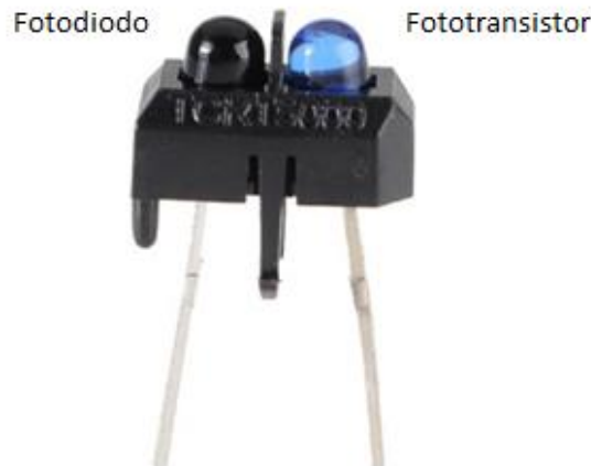
Figura 1.9. Sensor infrarrojo TCRT 5000.
