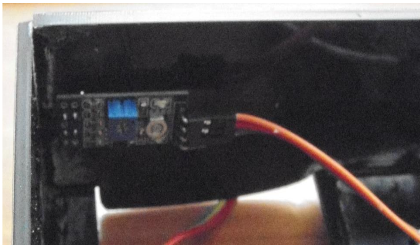
Figura 4.32: Instalación de Sensor TCRT5000
