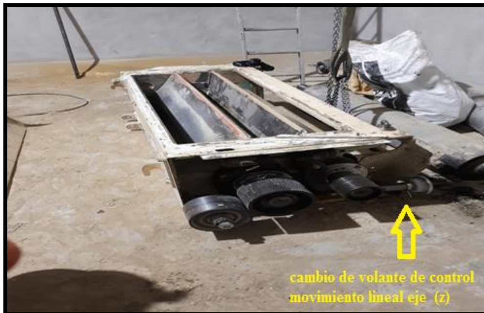
Figura. 4.6. Implementación mecánica volantes nuevos de control
