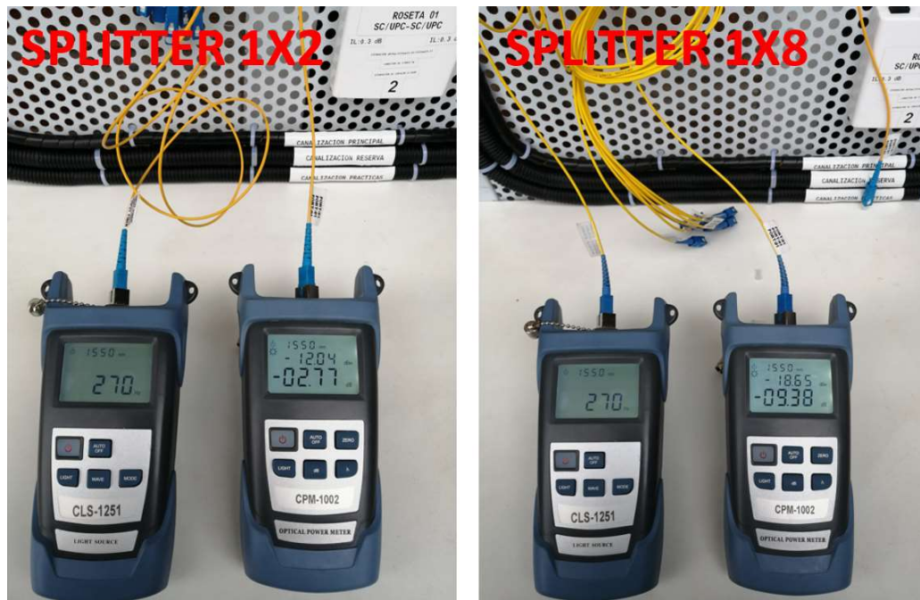
Figura 4.40 Pruebas de medidas de potencia en splitter
