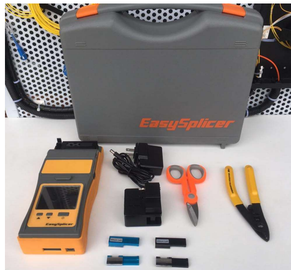
Figura 4.35 Equipos y herramientas del módulo experimental empalmes
