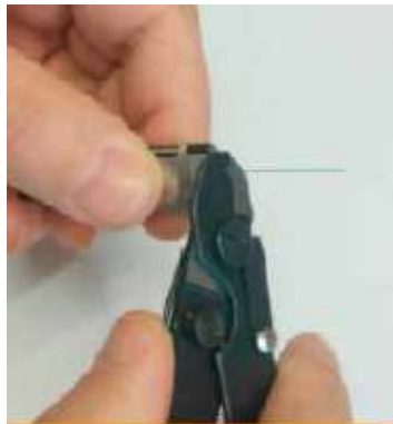
Figura 1.34 Extracción de la fibra óptica
