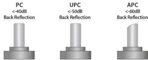
Figura 1.23 Tipos de pulido de conectores
