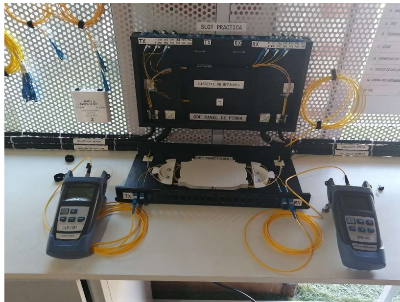
Figura E.21: Medición de enlaces, experimento 2
