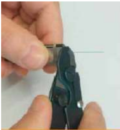
Figura B.9: Extracción de la fibra óptica
