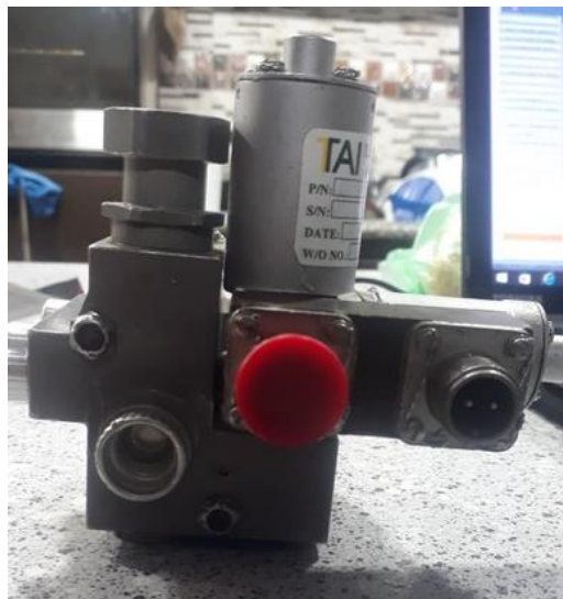
Figura. 3.11. Válvula neumática de 1000 psi marca AERO SPACE.
