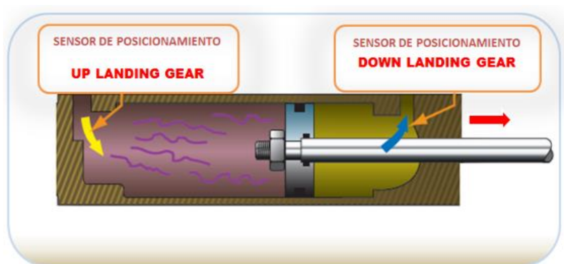
Figura. 4.4. Ubicación de los sensores de posición.
