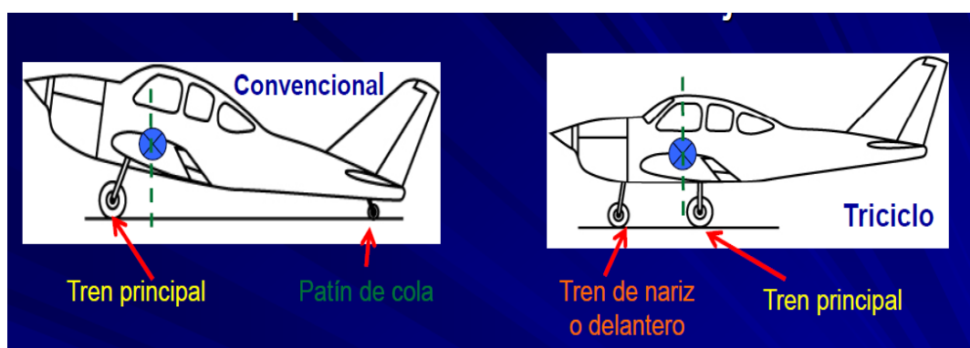
Figura. 1.4. Tipos de tren de aterrizaje.
