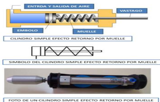
Figura. 1.18. Esquema de un cilindro de simple efecto.
