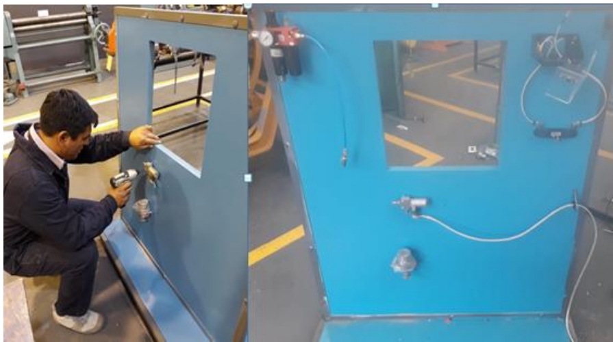
Figura. 4.33. Ubicación en el panel de control los componentes neumáticos.
