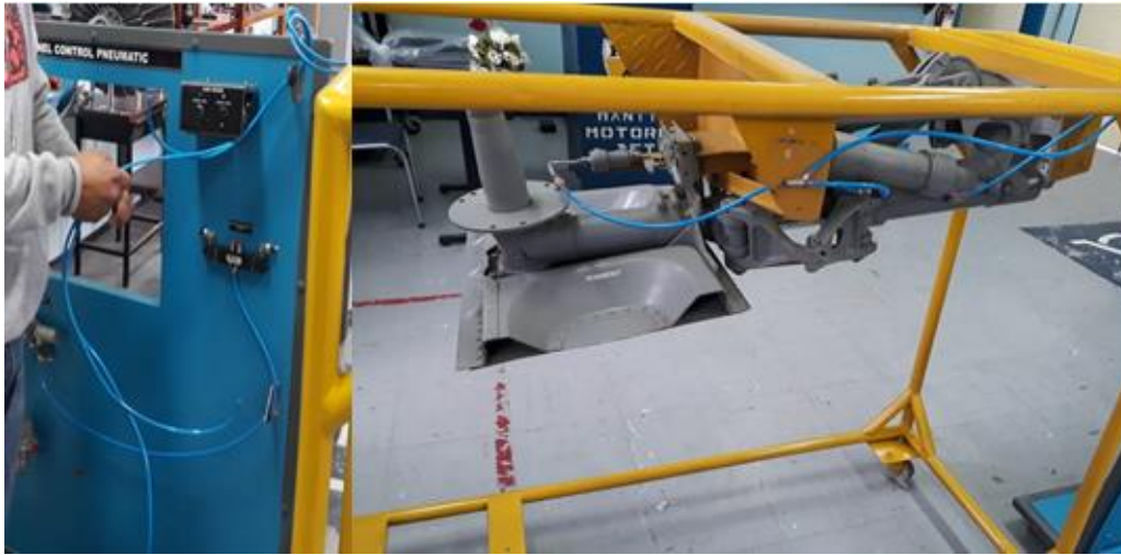
Figura. 4.35. Conexión de líneas neumáticas del panel de control con el tren de aterrizaje.
