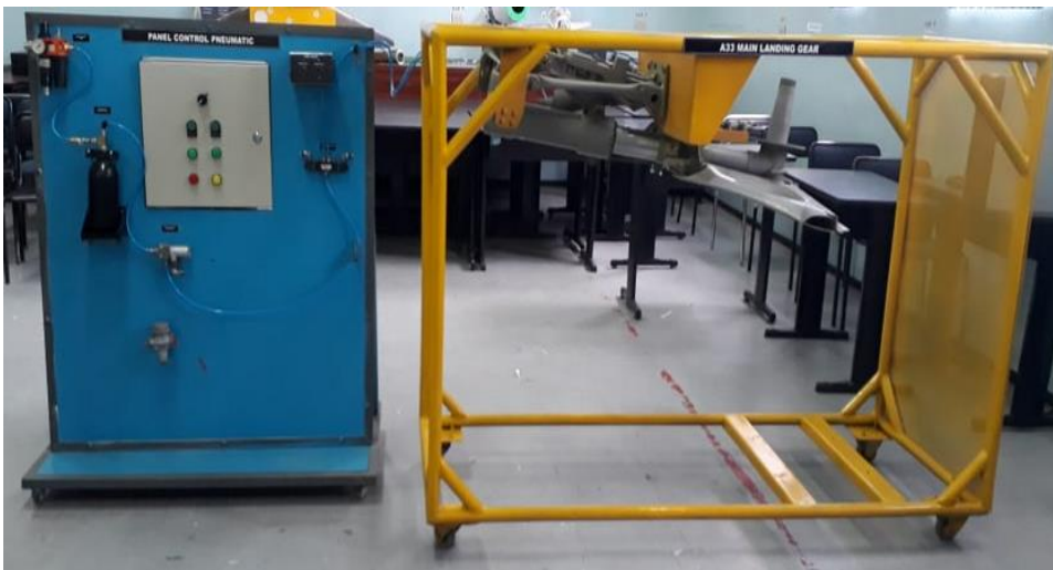
Figura. 4.36. Ensamblaje completo del sistema de retracción y extensión automatizado del tren de aterrizaje de la aeronave A-33.
