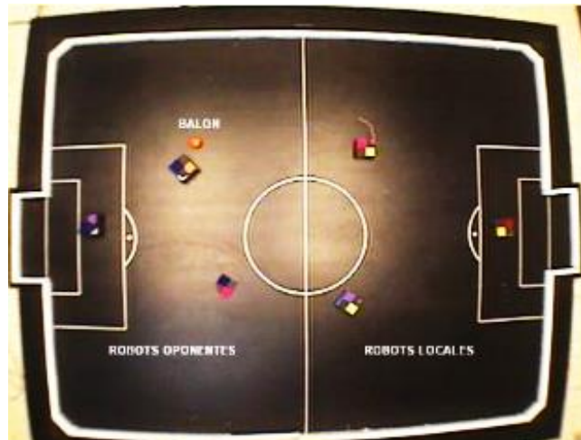
Figura 1.4. Sistema de fútbol robótico vista de la cámara cenital Fuente: (Chicala, Jacho, Atencia, & Vintimilla, 2006)
