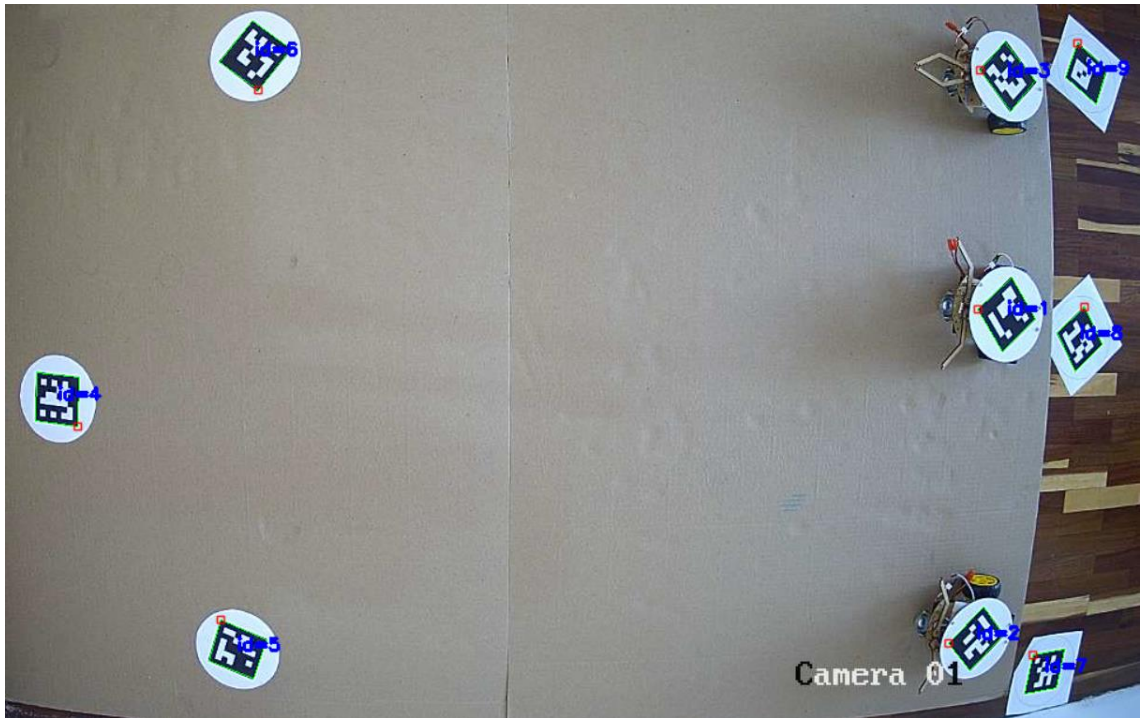
Figura 4.26. Detección de marcas Aruco vista aérea. Fuente: Elaborado por el autor
